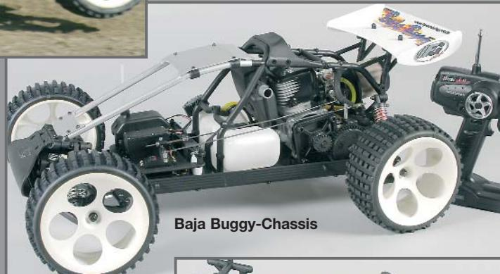
Ob Monster- oder Street-Modelle - all diese Modelle garantieren höchsten Spaßfaktor. Die Modelle werden fahrfertig montiert, mit eingefärbter und beklebter Karosserie, eingestellter Fernlenkanlage, Ladegerät und Akkus geliefert. Für ausreichend Power sorgt ein 26ccm Verbrennungsmotor mit eingebauter Zugstarteinrichtung.
